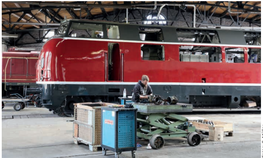
Aufarbeitung von Motorkomponenten der V 200.1
