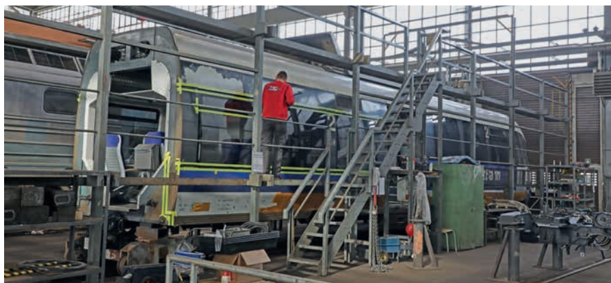
Sanierung von Fugen an einem Talent-1-Dieseltriebwagen
