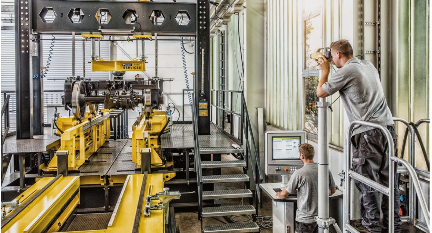
Rund eine Million Euro hat PRS in eine Prüfanlage für Radsätze und Drehgestelle investiert.
